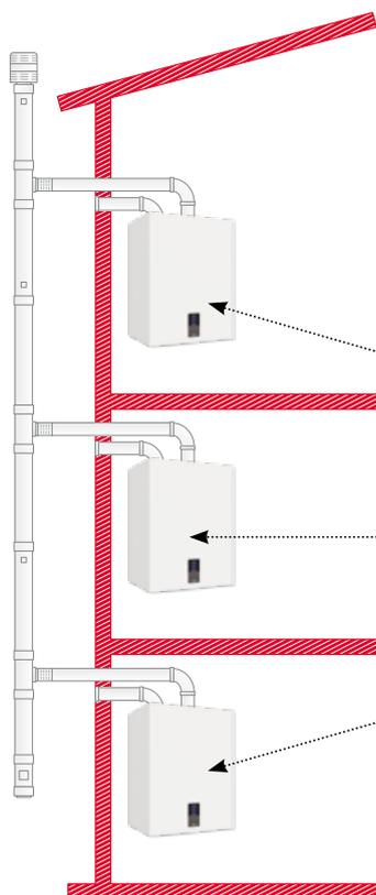
**F.P.S.:** Sistema di Protezione Fumi. La valvola clapet fumi (installata di serie) permette una **facile connessione a sistemi collettivi fumari in pressione** (es. nei risanamenti), in accordo alla normativa UNI 7129. **Per gli installatori** la soluzione della canna collettiva in pressione è **più economica** (riduzione dei diametri dei camini).
