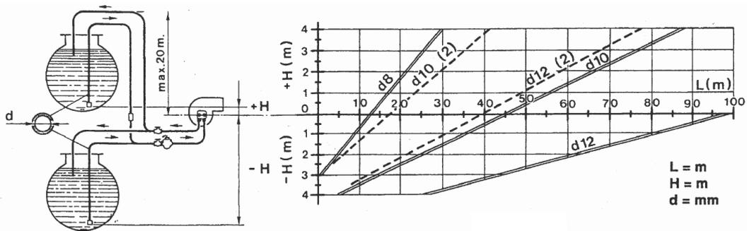
N. B.: Se la lunghezza della tubazione supera 60m, si consiglia una pompa di alimentazione - d10 (2), d12 (2): per bruciatori a due fiamme.
