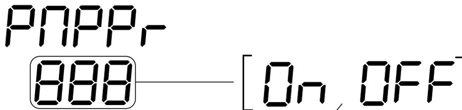
Tramite pressione del tasto i si accede alla modalità MODIFICA VALORE PARAMTERO, durante la quale il valore del parametro visualizzato lampeggia.
