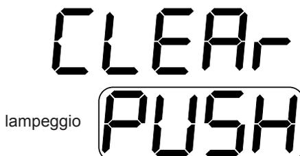
Una ulteriore pressione del tasto i durante questa visualizzazione determina l'azzeramento di tutti i contatori relativi alle ore di funzionamento ed il ritorno alla visualizzazione ore di funzionamento primo stadio
