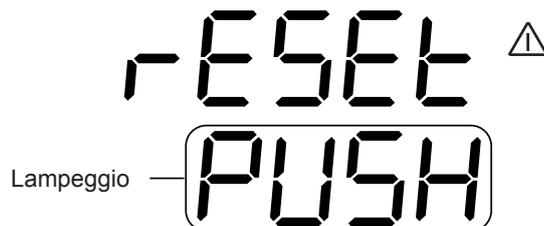
Una ulteriore pressione del tasto R provoca lo sblocco dell'apparecchiatura e il ritorno alla modalità di visualizzazione normale.
