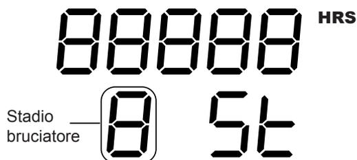
Vengono inoltre visualizzate le ore complessive di funzionamento del bruciatore.
