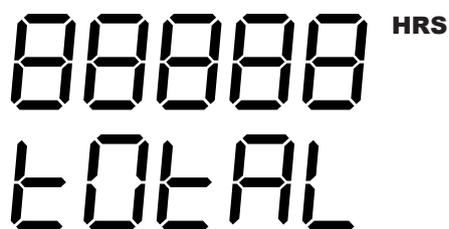
Per azzerare tutti i contatori relativi alle ore di funzionamento del bruciatore è necessario premere il tasto i durante la seguente visualizzazione:
